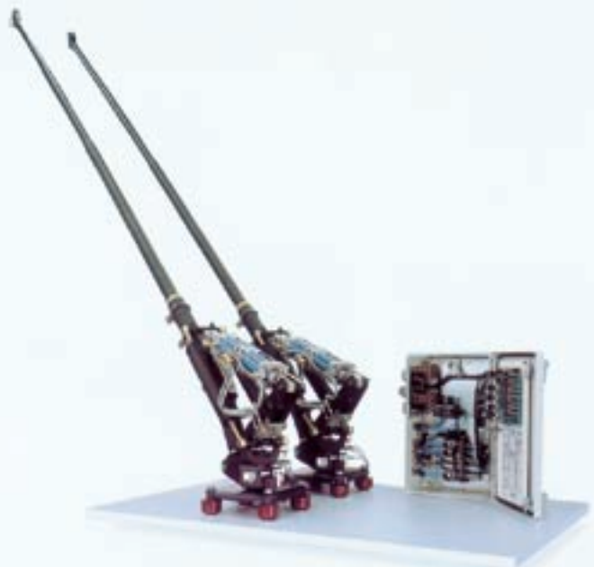
O-Bus-Stromabnehmer mit Steuergerät Trolley per filobus con apparecchio di comando
